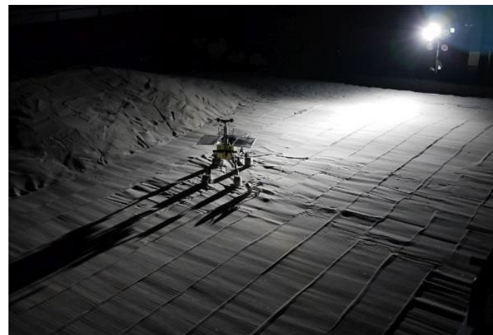
400m 2 の『宇宙探査フィールド』 珪砂と岩石模型により月惑星の表面地形を模擬
