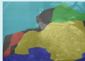
図2. 深層学習AIによる映像認識例 (左): 赤外線画像 (模擬岩盤掘削中) (右): 領域認識 (黄: 掘削塊、緑: トンネル断面)
