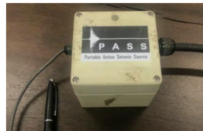
図2 地球用に開発が進められている超小型振動励起源
