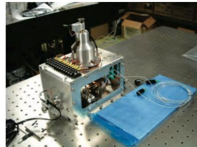
図1 プロトタイプとして開発した光学干渉式地震計
