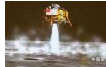
嫦娥 3 号( www.chinamil.com.cn )(中国, 2013) 7.5kNUDMH/NT0 エンジン(20～100%スロットリング) Wet 約3.7t, Dry 約1.2t
