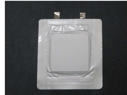
宇宙探査イノベーションハブで開発したラミネートタイプの全固体リチウムイオン電池(LiB)の外観
