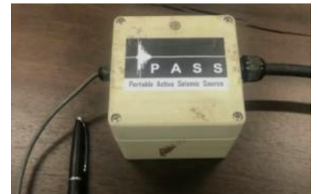
図2 地球用に開発が進められている超小型振動励起源
