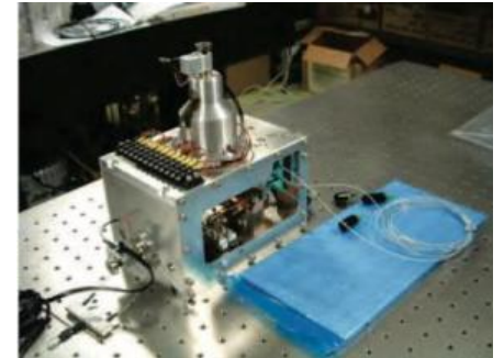
図1 プロトタイプとして開発した光学干渉式地震計
