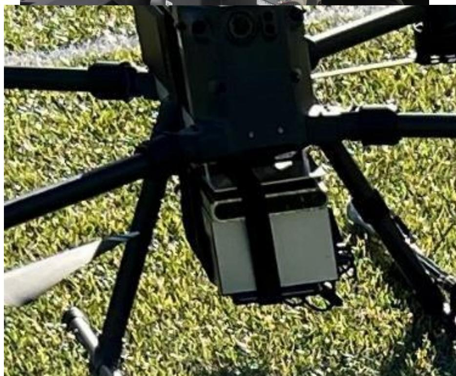
携帯電話回線を使う通信モジュールにより、飛行中に捕集と分析を行い、データを受信できる。
