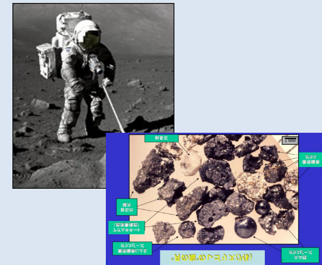
アポロ17号の船外宇宙服の月レゴリスの付着 (JAXA宇宙教育センター 月面の環境より)
