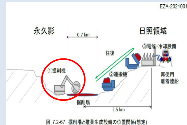
月面推薬生成プラントの建設機械
