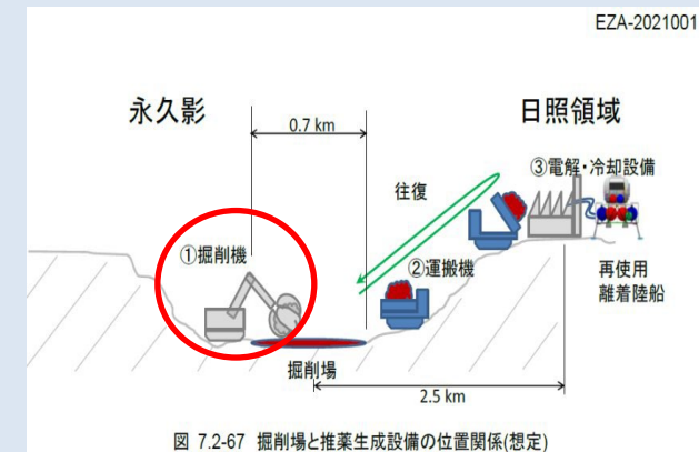
月面推薬生成プラントの建設機械
