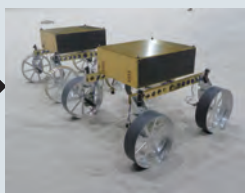
建機模型/試験モデル→試験プラットフォーム車両→建設機械と段階的に試験を実施
