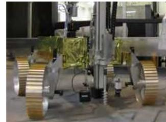
月面探査ローバ搭載のアースオーガを用いた調査手法の確立
