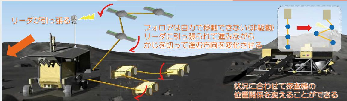
ブレーキ制御型フォロワ探査機
