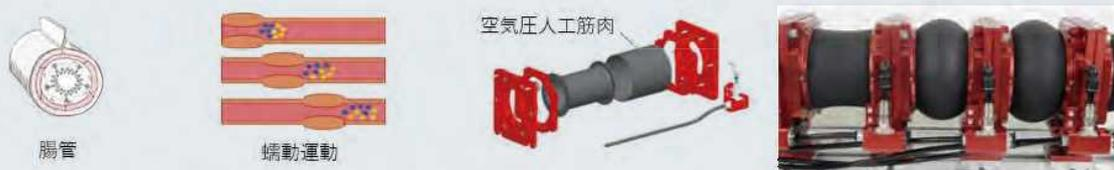
1) 固体ロケット推進薬の製造工程における材料の連続捏和・搬送技術を確立する
