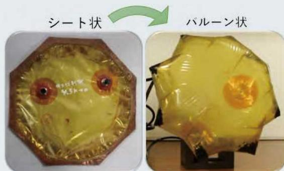
溶着により製作したPIバルーン
