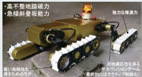
マルチクローラ探査ロボット「健気」
