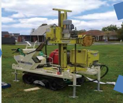
現行のSDSにアースオーガを組み込んだ今までにない地盤調査手法を確立。地上でのデータを蓄積し、更なる進化へ。
