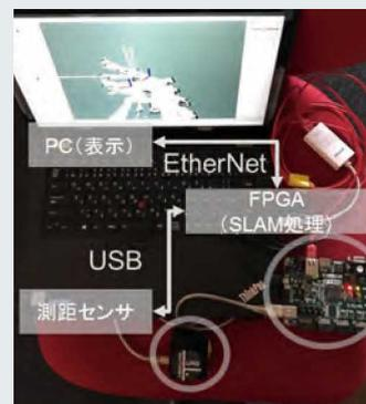
省電力型ロボット計算機システムの検討
