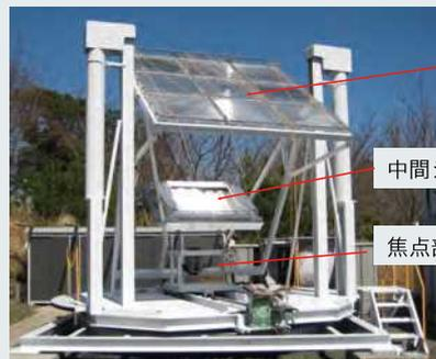
10 kW 大型太陽炉
