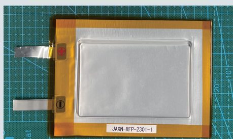
イオン液体リチウムイオン電池(試作品): 2600 mAh
