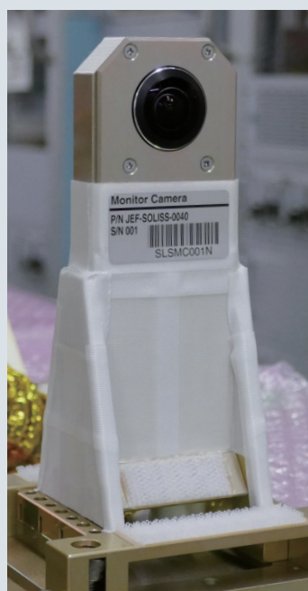
図1 宇宙用全天球カメラ SOLISSのモニタカメラとして 組み付けられた状態
