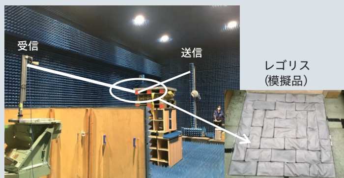
図1：電波暗室での月面大地反射測定の測定系
