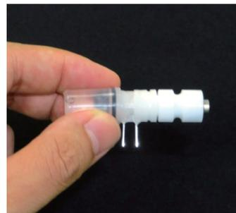
図3. 電気浸透アクチュエータ試作モデル
