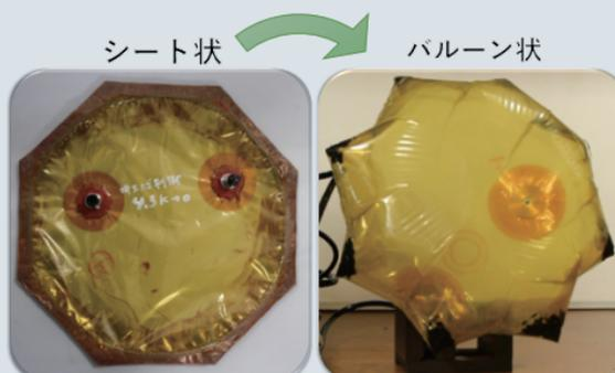
溶着により製作したPIバルーン
