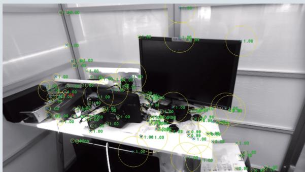
オフィスシーンのVisualSLAM処理例（1）：（左）取得画像と抽出した画像特徴の重畠表示、（右）得られた3次元環境地図とカメラ位置：空間中の点が特徴点の3次元位置を表し、手前の緑枠線がカメラ位置を示している
