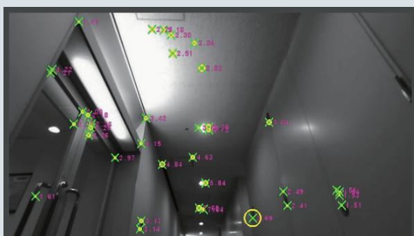
オフィスシーンのVisualSLAM処理例（2）：（左）取得画像と抽出した画像特徴の重畠表示（テクスチャレス部分の特徴抽出が工夫されている）、（右）得られた3次元環境地図とカメラ位置
