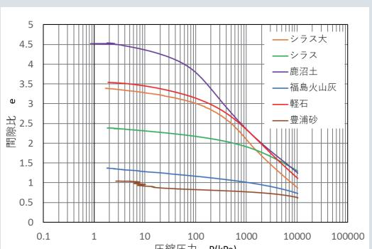
1次元圧縮試験で、固結状態を確認
