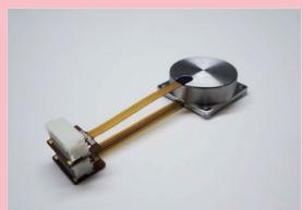
レゾルバは電磁誘導現象を利用し、回転角度や位置を検出するセンサで、回転または直進の変位を検出する磁気式のアブソリュートセンサ。レゾルバは構造が比較的簡単で丈夫、耐環境性に優れてる等の利点がある。
