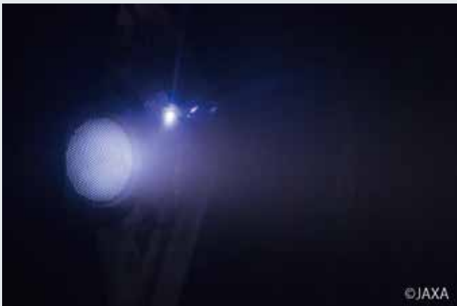
図1 試験中のイオンエンジン中和器の写真
