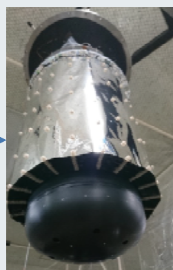
NICS-MLIと熱針ラミネート型MLIの複合構成検討・性能評価
