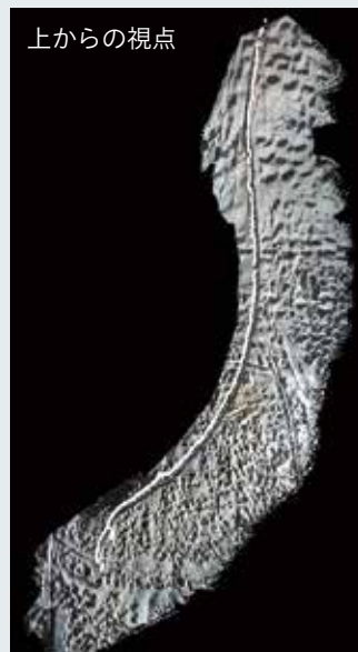
Point-Plane SLAM により計測した移動経路 (白線) と 3次元環境地図
