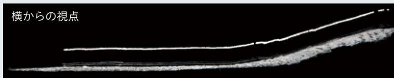
Point-Plane SLAM により計測した移動経路 (白線) と 3次元環境地図
