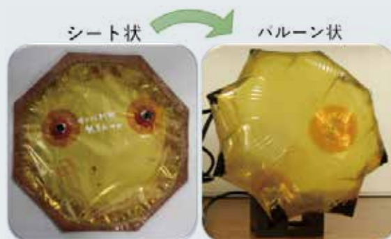
溶着により製作したPIバルーン (展開前の外径円直径300mm)
