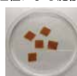
積層断熱材用素材の滅菌 積層断熱材素材のプラズマ滅菌 と素材適合性の調査。
