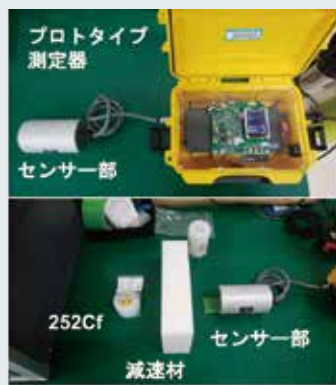
(左図) ^{252}\text{Cf} と減速材を用いた中性子測定の様子、(右図)放射線イベントの熱中性子とガンマ線の分離の様子。
