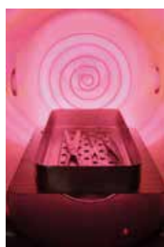
滅菌・防黴用プラズマ源 低压酸素プラズマ滅菌器(左) および大気圧バリア放電装置(上)。
