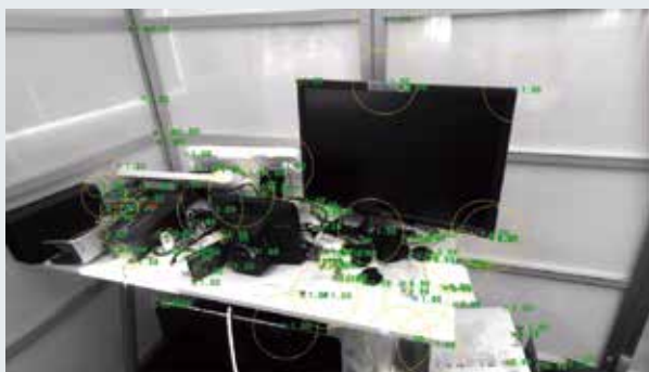
オフィスシーンのVisualSLAM処理例（1）：（左）取得画像と抽出した画像特徴の重畳表示、（右）得られた3次元環境地図とカメラ位置：空間中の点が特徴点の3次元位置を表し、手前の緑枠線がカメラ位置を示している
