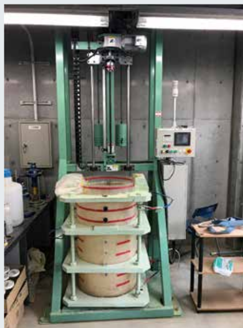
写真1 地上応用を想定した掘進制御の可能な大型掘削試験機
