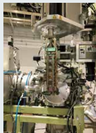
陽子線照射試験の様子 @若狭湾エネルギーセンター
