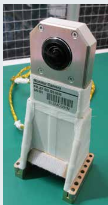
図3 軌道上実証後のモニタカメラ
