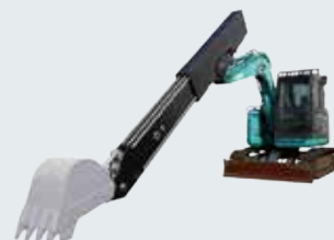
7tonクラス油圧ショベル用 CFRP製テレスコープアーム 油圧ショベル取付状態（実物）
