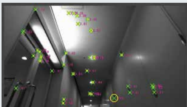
オフィスシーンのVisualSLAM処理例（2）：（左）取得画像と抽出した画像特徴の重畳表示（テクスチャレス部分の特徴抽出が工夫されている）、（右）得られた3次元環境地図とカメラ位置
