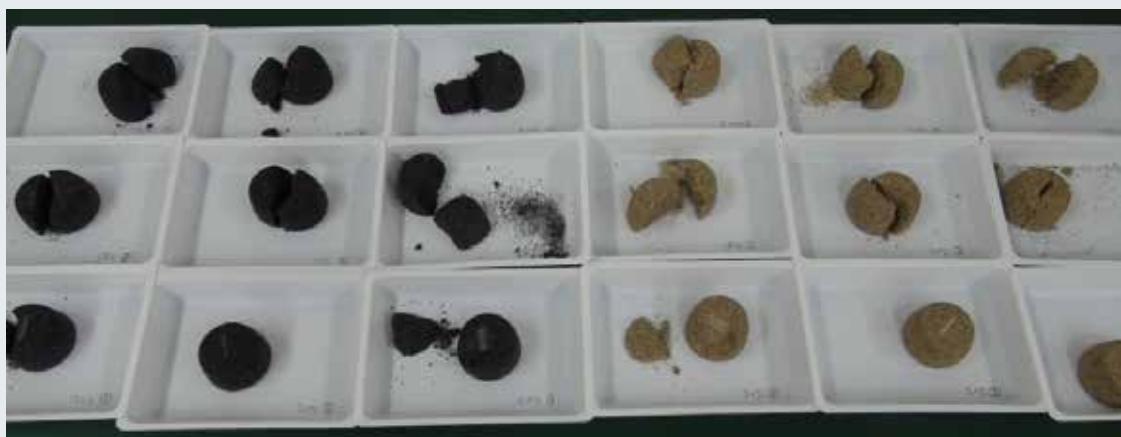
強度試験後の試験体
