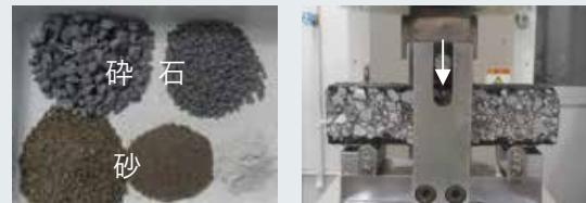
鉄化合物を含む碎石や砂を舗装に用いることで、誘導加熱により舗装が加熱され、ひび割れが修復できた。
