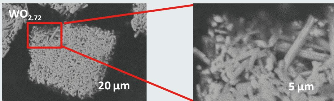
生成した酸素欠損型酸化物
