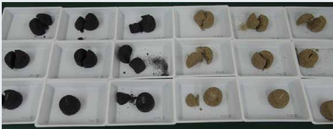
強度試験後の試験体
