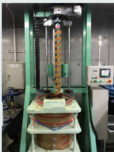
写真1 地盤定数の推定手法の検討に 使用した掘進制御の可能な大型 掘削試験機
