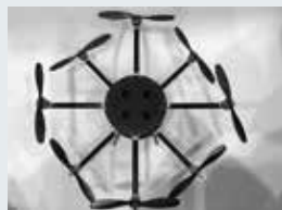
Fig.3: ロータ配置を上下それぞれ4ロータにした実験装置。
