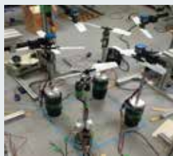
Fig.3: ロータ配置を上下それぞれ4ロータにした実験装置。
