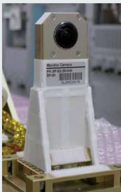
図1 宇宙用全天球カメラ SOLISSのモニタカメラとして 組み付けられた状態
