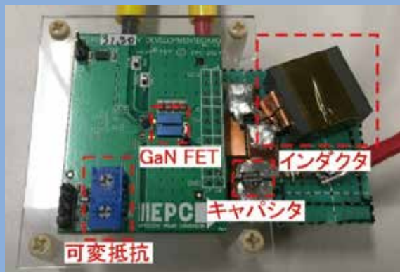
図2 非絶縁形DC-DCコンバータ
