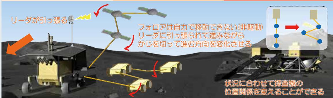
ブレーキ制御型フォロワ探査機
