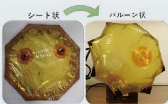
溶着により製作したPIバルーン
