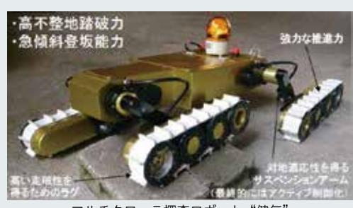
マルチクローラ探査ロボット“健気”
