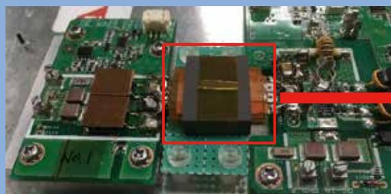
図1 絶縁形DC-DCコンバータ (LLC共振形)
