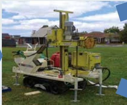
現行のSDSにアースオーガーを組み込んだ今までにない地盤調査手法を確立。地上でのデータを蓄積し、更なる進化へ。
