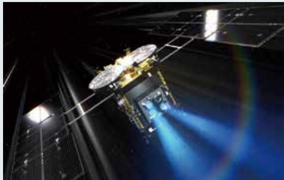
イオンエンジンは「電気推進」と呼ばれ、外部からの電力を推進力に利用することができる。軽量で高効率の電源は、宇宙機の軽量化ひいては高い加速度を実現することになる。
