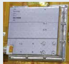
はやぶさ2 イオンエンジン用直流電源 (効率84%)
