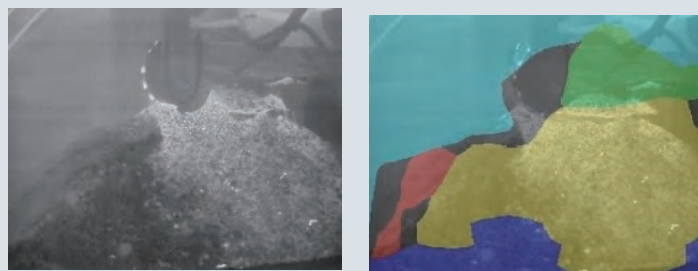
図4. AI深層学習による映像認識例 左：元画像（模擬岩盤掘削中） 右：領域認識（黄色：ズリ掘削塊、緑色：トンネル断面）
