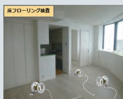
複数小型ロボットが協調し拡散するシステムを用いて、建設現場や老朽化インフラにおける、作業進捗確認やモニタリング、点検や調査を行います
