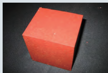
C. 圧縮後 容器からの取り出し
