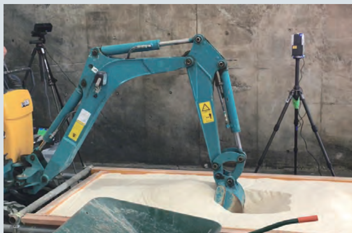
ミニバックホウによる掘削実験
