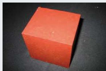
C. 圧縮後 容器からの取り出し
