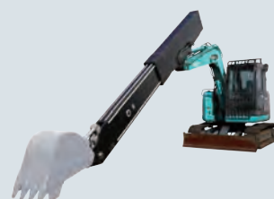
7tonクラス油圧ショベル用 CFRP製テレスコープアーム 油圧ショベル取付状態（実物）
