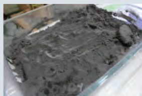
月の砂を模した砂を用い、プロトタイプ装置による凍結乾燥実験を行った。
