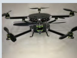
Fig.3: ロータ配置を上下それぞれ4ロータにした実験装置。
