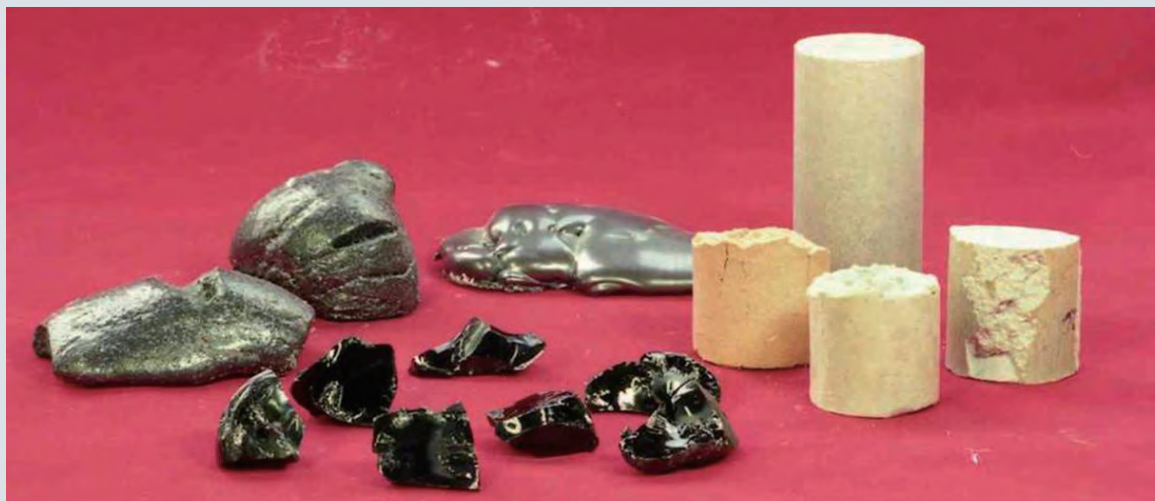
作製例：マイクロ波利用（左）、コールドプレス法利用（右）
