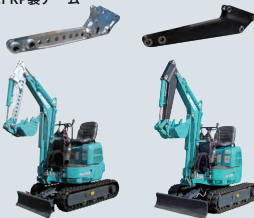
軽量金属製アーム 油圧ショベル取付状態（実物） CFRP製アーム 油圧ショベル取付状態（実物）
