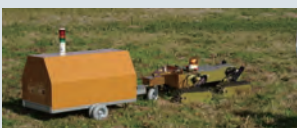
計器を搭載した台車を連結した「健気」
