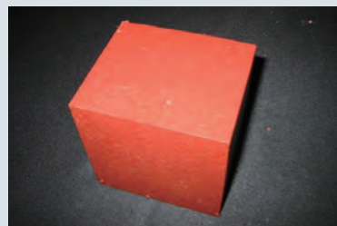
C. 圧縮後 容器からの取り出し
