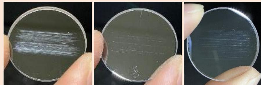
レゴリスシミュラントを用いて擦過摩耗試験後の各種サンプル
