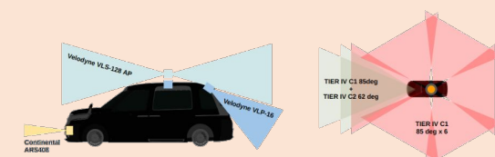
ロボットタクシー センサシステム例
