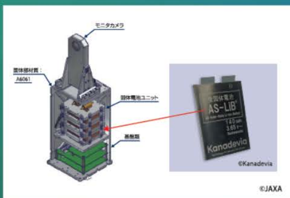
Space AS-LiB 構成(左)と AS-LiB ® 140mAh セル 破壊テスト
