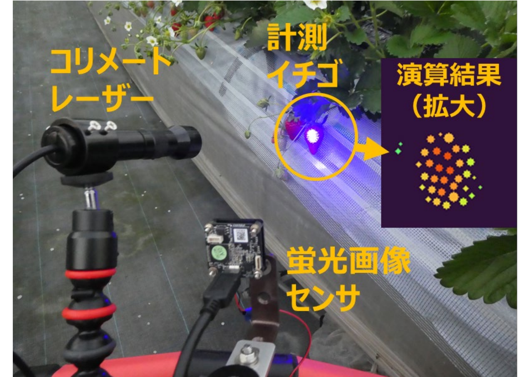
栽培イチゴへレーザーを照射し 蛍光画像を計測
