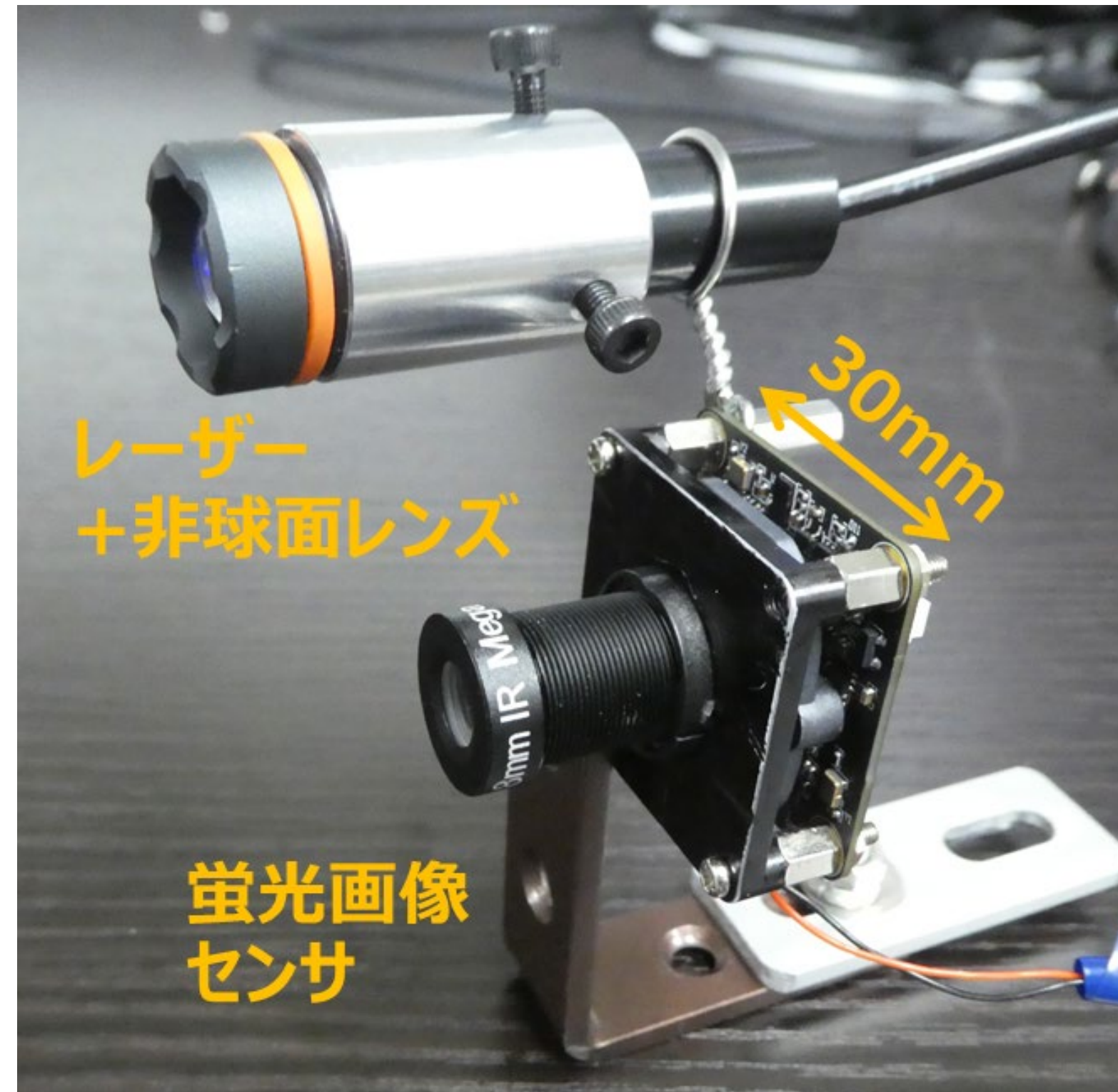
開発した蛍光画像センサと 照射用レーザー
