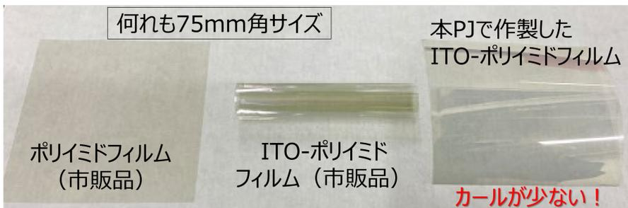
図6 成膜したITOポリイミドフィルム
