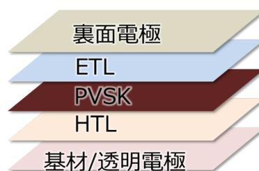
図10 逆型デバイスの構造
