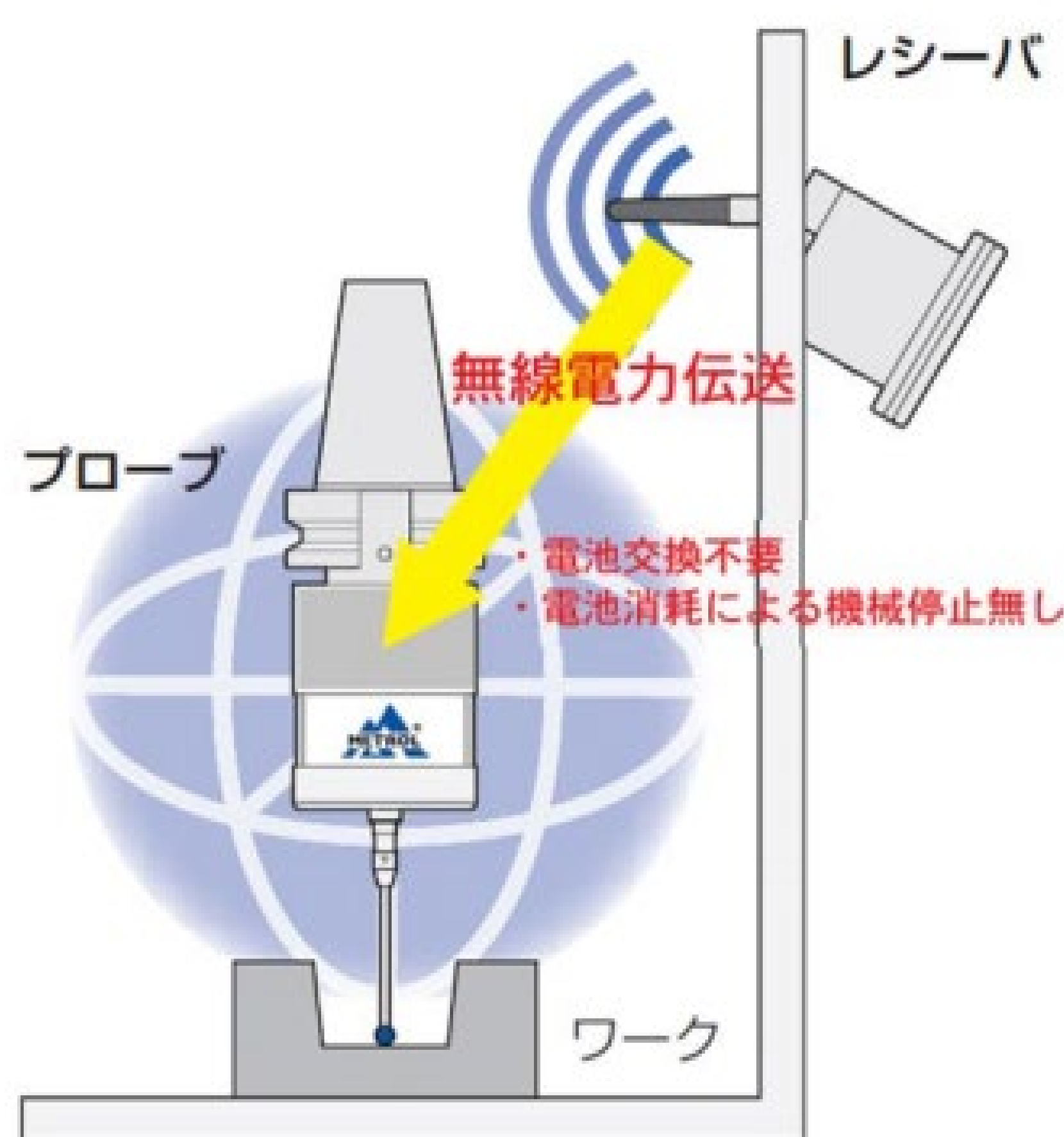
図3 工作機械内のタッチプローブへの無線電力伝送(WPT)のイメージ
