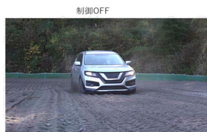
地表面からの沈み込みが大きく、砂をかき分けながら進む
