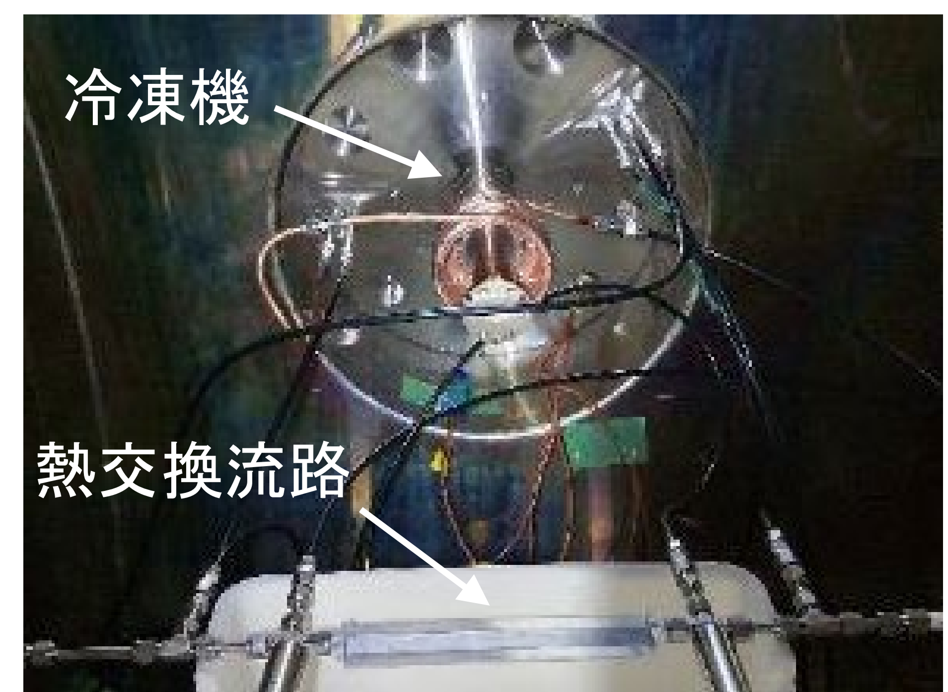
図2 冷凍機による真空熱交換試験
