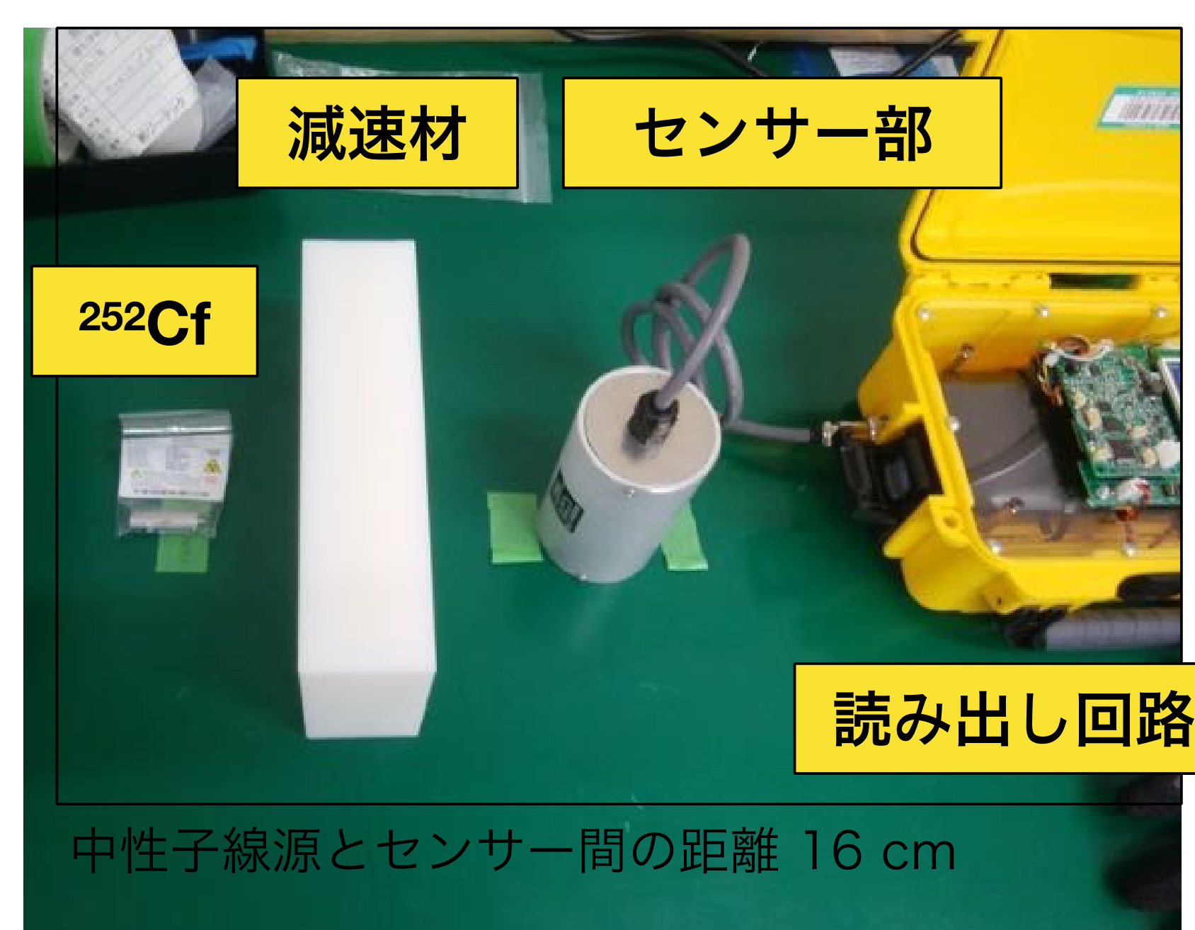
図5. 中性子の基礎測定の様子
