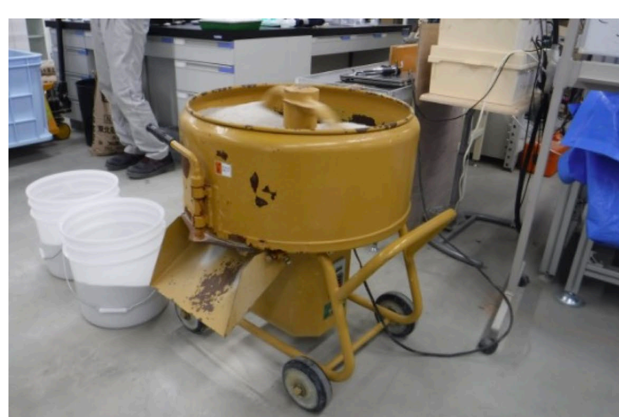
霧吹きによる含水・攪拌
