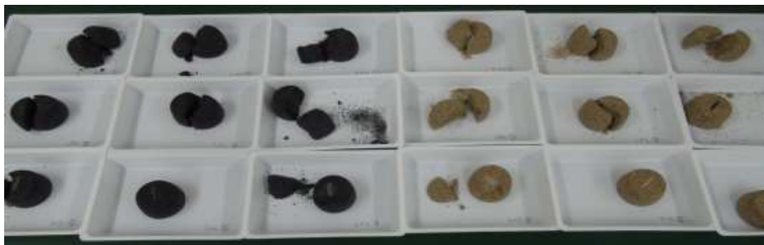
強度試験後の試験体
