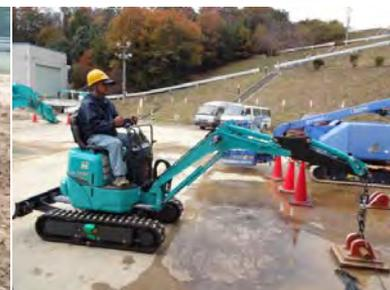
アームを油圧ショベルへ取り付けた状態で各種評価試験を実施
