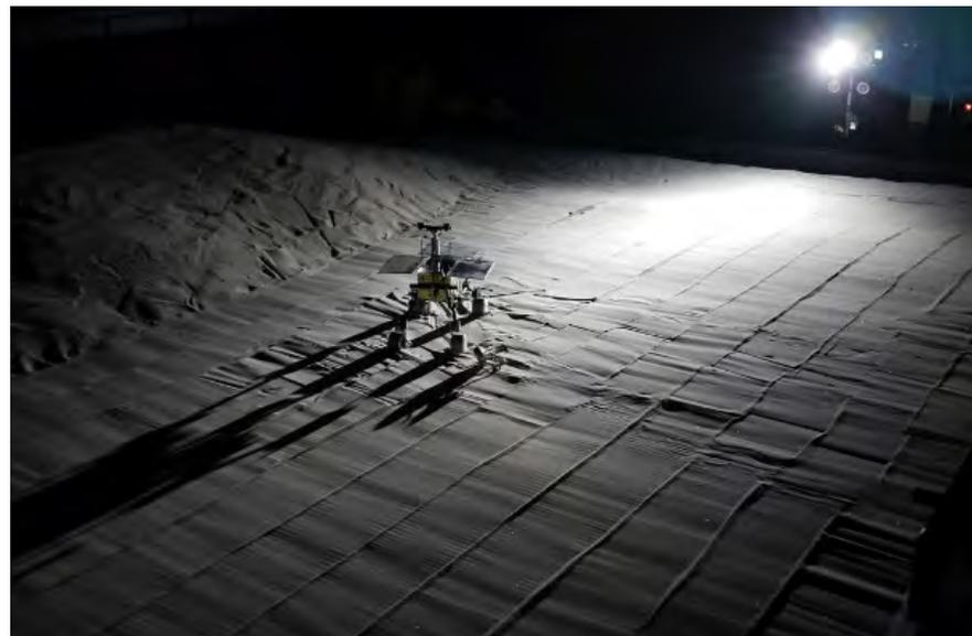
屋内実験場『宇宙探査フィールド』は砂礫や岩などによって起伏のある月惑星の表面地形を模擬している。
