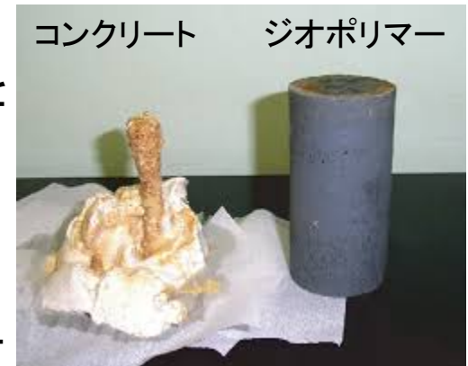
コンクリートとジオポリマーの酸浸漬実験(鉄道総研報告:より抜粋)
